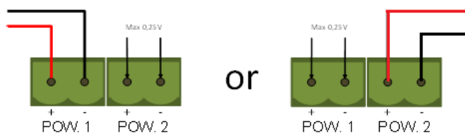
Abb. 11- Maximale Spannung am nicht angeschlossenen Netzstecker
